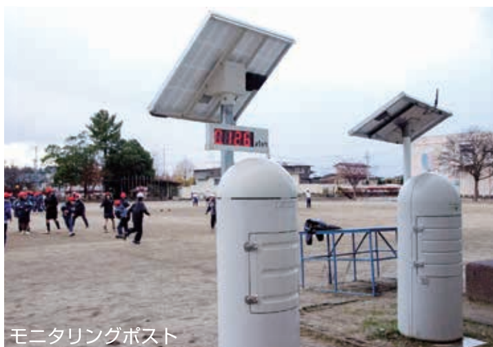
大気中の放射線量を測定し機器の表示部に測定結果を表示
